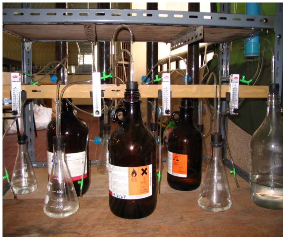
รูปที่ 3.10 ชุดสร้างไออะซิโตนและการติดตั้งRotameter
