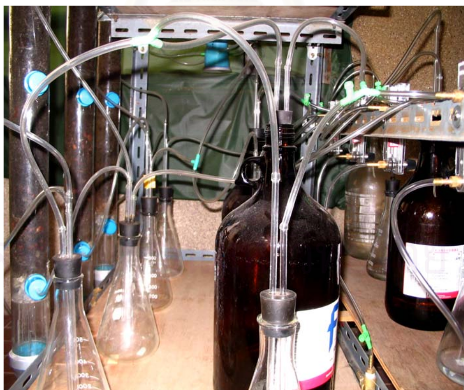
รูปที่ 3.11 ชุดการสร้างไออะซิโตนและชุดสร้างความชื้นสัมพัทธ์อากาศ
