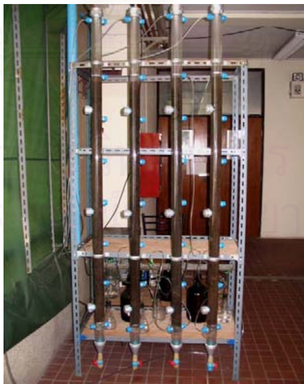
รูปที่ 3.9 ชุดการทดลองเครื่องกรองชีวภาพ
