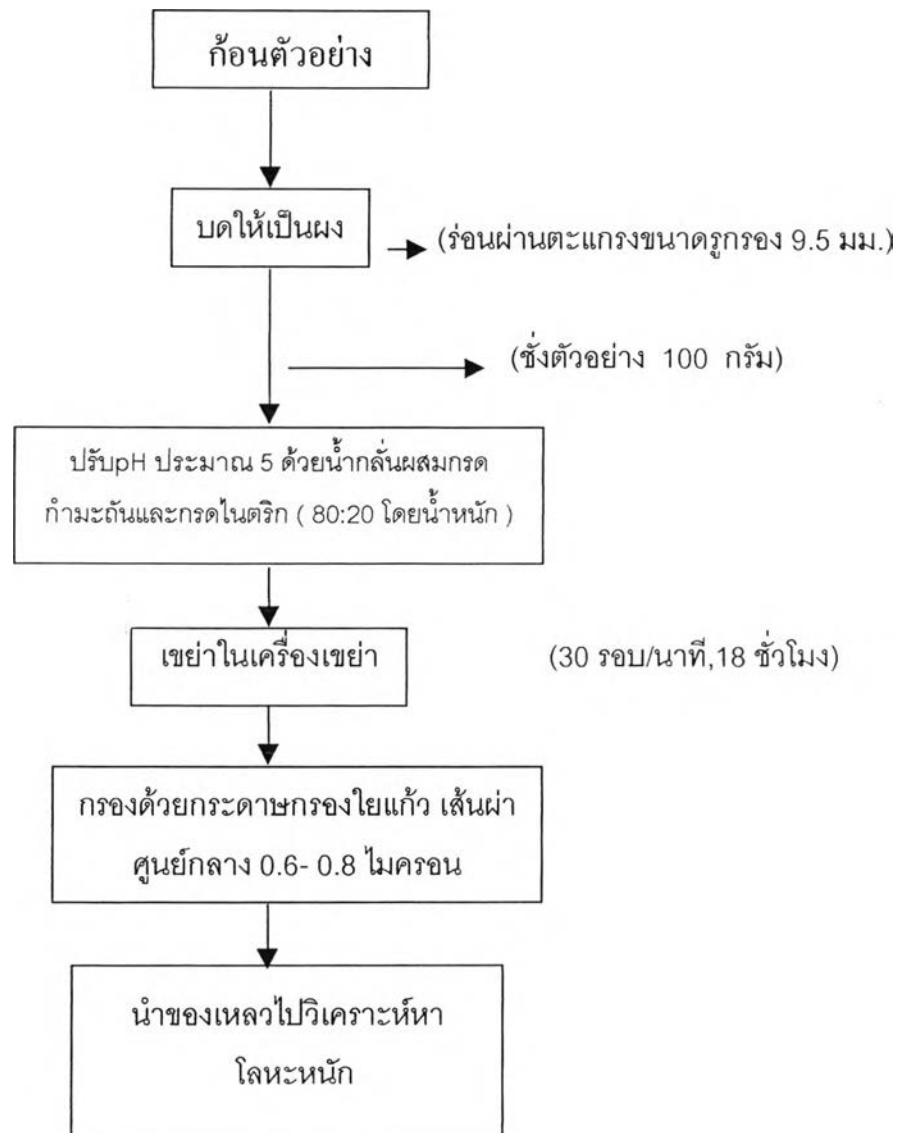
รูปที่ 4.1 แผนผังแสดงการทดสอบการชะละลายของโลหะหนักตามประกาศกระทรวงอุตสาหกรรม ฉบับที่ 6 ( พ.ศ. 2540 )
