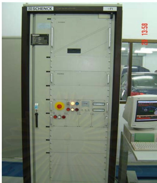
รูปที่ 4-27 (ข) แสดงรูปเครื่องควบคุม Dynamometer
