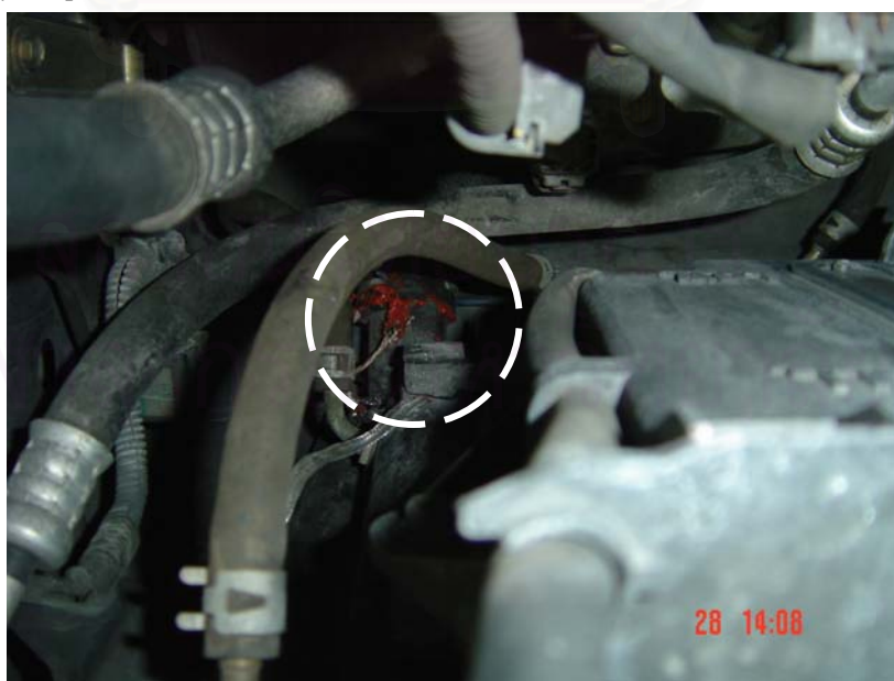
รูปที่ 4-21 แสดงตำแหน่งการวัดอุณหภูมิน้ำหล่อเย็นที่ทางเข้าเครื่องยนต์
