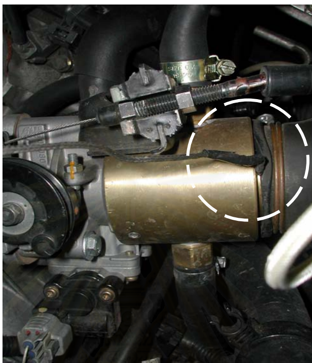
รูปที่ 4-24 แสดงตำแหน่งการวัดอุณหภูมิไอดี
