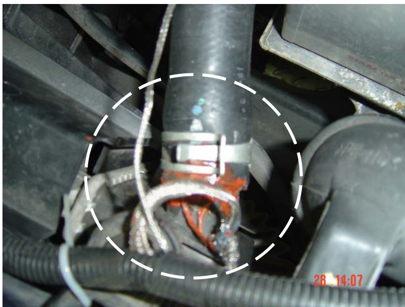
รูปที่ 4-22 แสดงตำแหน่งการวัดอุณหภูมิน้ำหล่อเย็นที่ทางออกเครื่องยนต์
