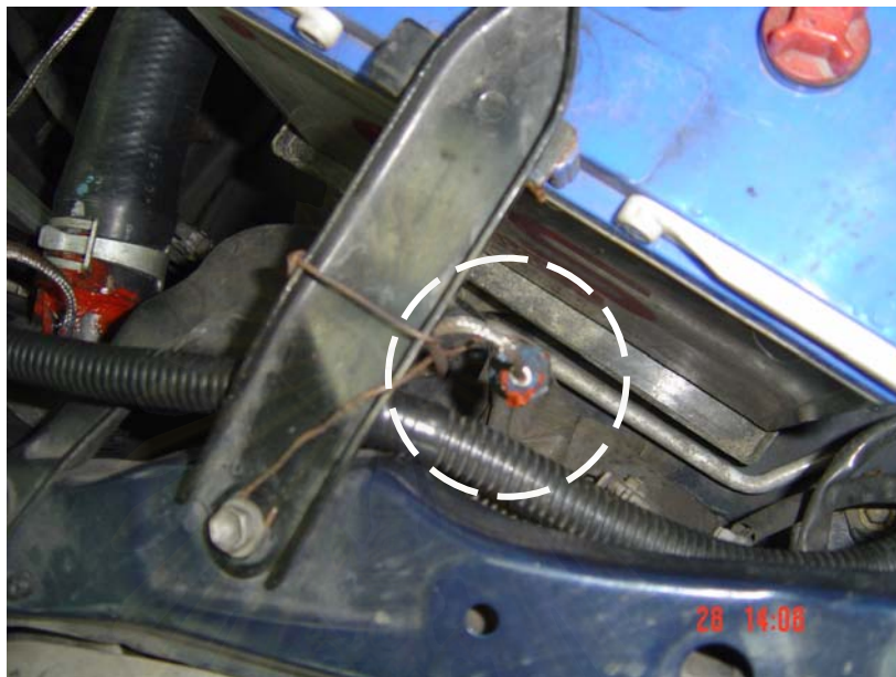
รูปที่ 4-26 แสดงตำแหน่งการวัดอุณหภูมิบริเวณห้องเครื่อง
