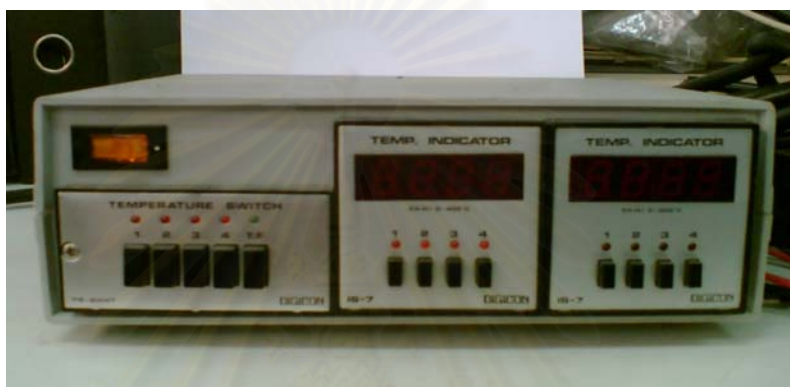
รูปที่ 4-20 แสดงภาพตัวอ่านค่าอุณหภูมิ และชุดเพิ่มตำแหน่งการอ่านค่าอุณหภูมิ
