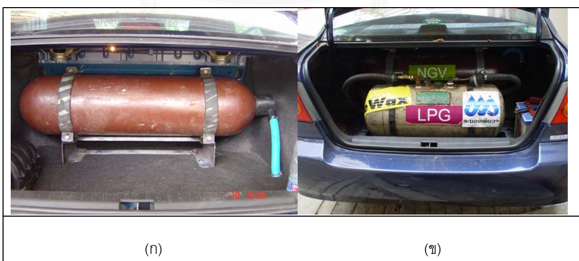
รูปที่ 4-45 แสดงภาพขาตั้งและตำแหน่งการยึดติดตั้งก๊าซกับตัวรถ
