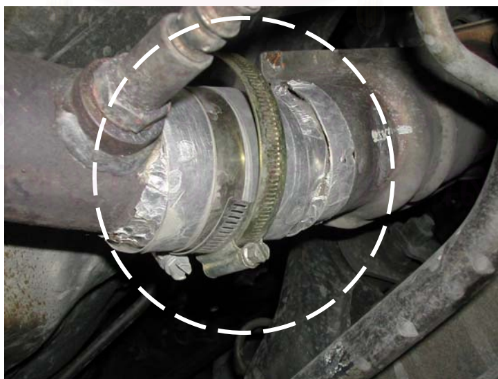
รูปที่ 4-25 แสดงตำแหน่งการวัดอุณหภูมิไอเสีย
