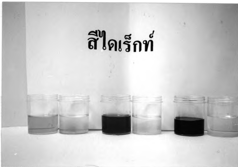
รูปที่ 4.10 น้ำเสียสีข้อมโคเร็กซ์ก่อนและหลังการบำบัดด้วยกระบวนการเมมเบรน อัลตราฟิลเตรชัน ที่ความดัน 2 บาร์ และพีเอชของน้ำเสียประมาณ 7
