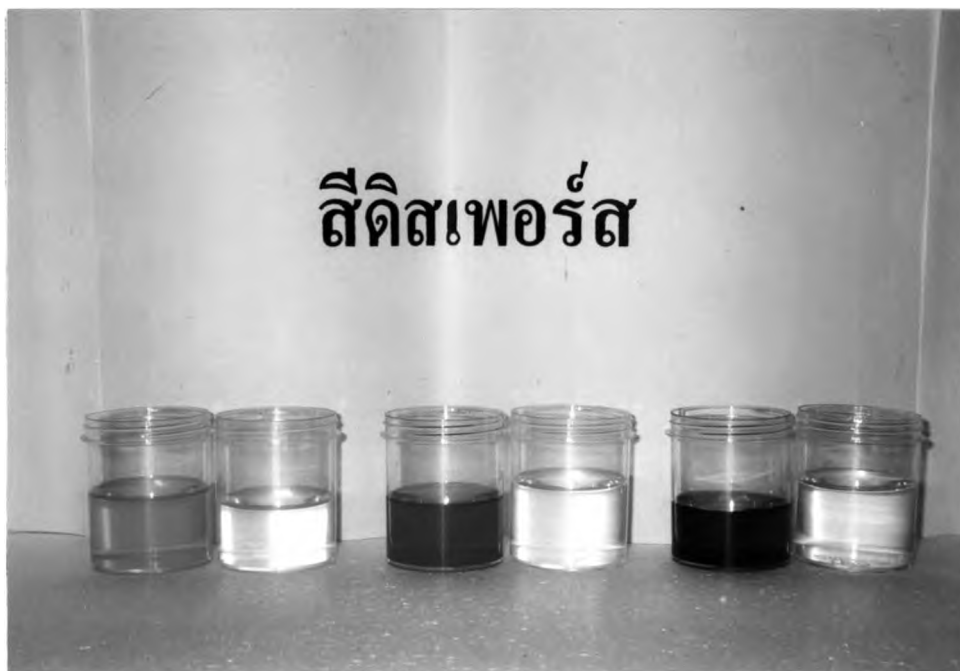
รูปที่ 4.9 น้ำเสี้ยวสีข้อมดิสเพอร์สก่อนและหลังการบำบัดด้วยกระบวนการเมมเบรน อัลตราฟิลเตรชัน ที่ความดัน 2 บาร์ และพีเอชของน้ำเสี้ยวประมาณ 7
