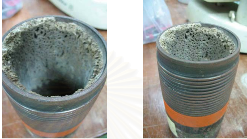
รูปที่ 3.3 ลักษณะของตัวอย่างตะกอนในท่ออุปกรณ์
