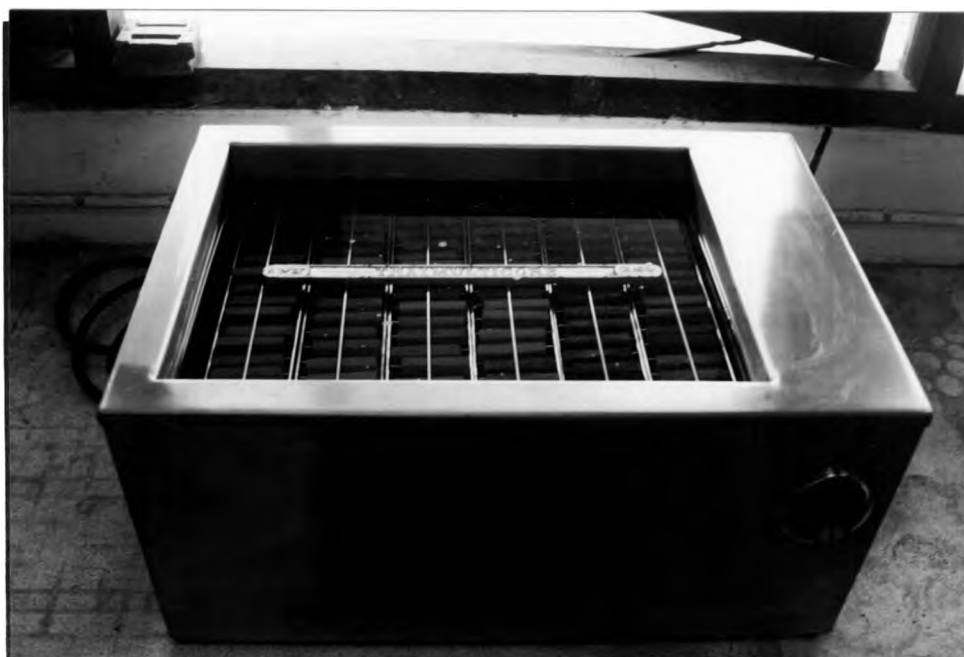
รูปที่ 3.7 การศึกษาความคงทนด้วยวิธีตามมาตรฐานผลิตภัณฑ์อุตสาหกรรม (มอก.285)
