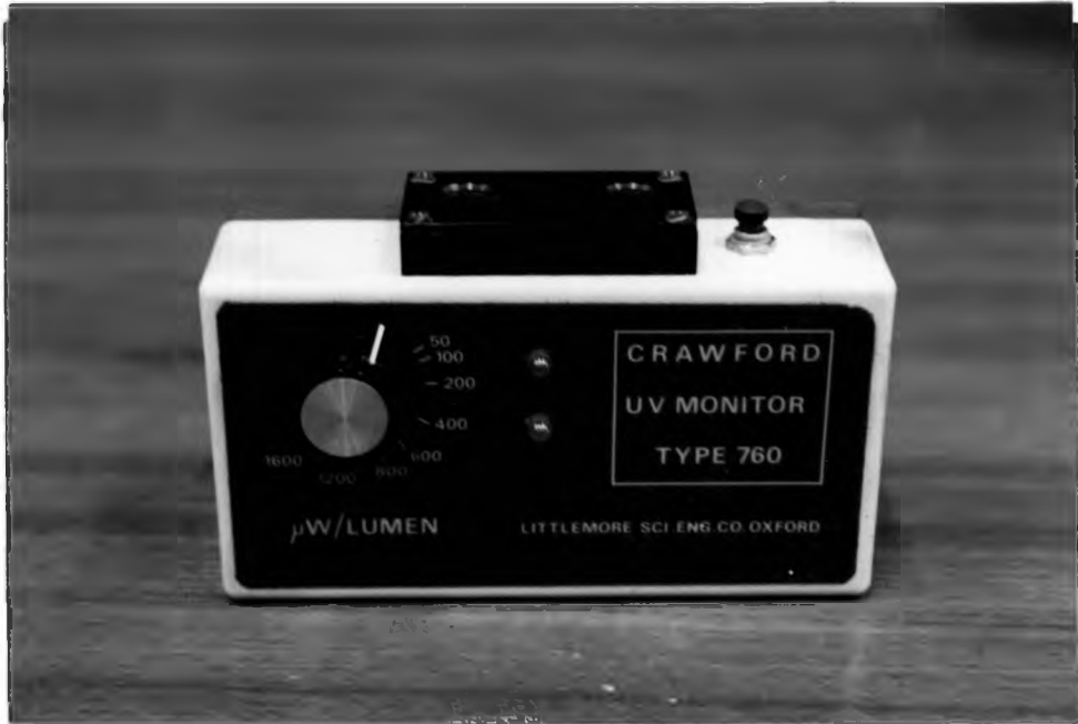
รูปที่ 3.3 เครื่องยูวีมิเตอร์ (Crawford UV-monitor type 760)
