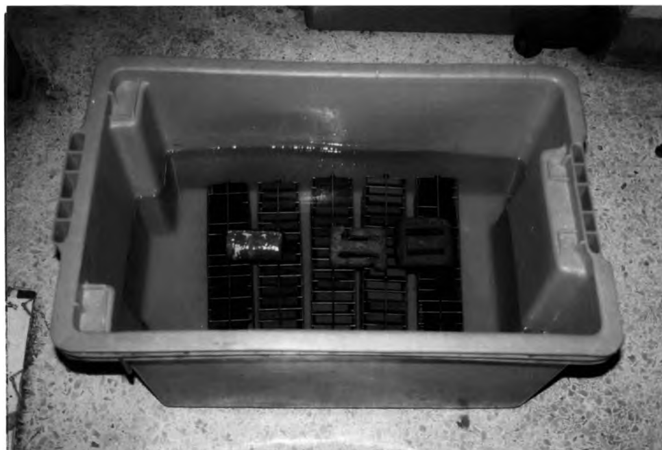
รูปที่ 3.9 การศึกษาความคงทนด้วยวิธีแบบวงจร (แช่น้ำที่อุณหภูมิห้อง เป็นเวลา 2 วัน)
