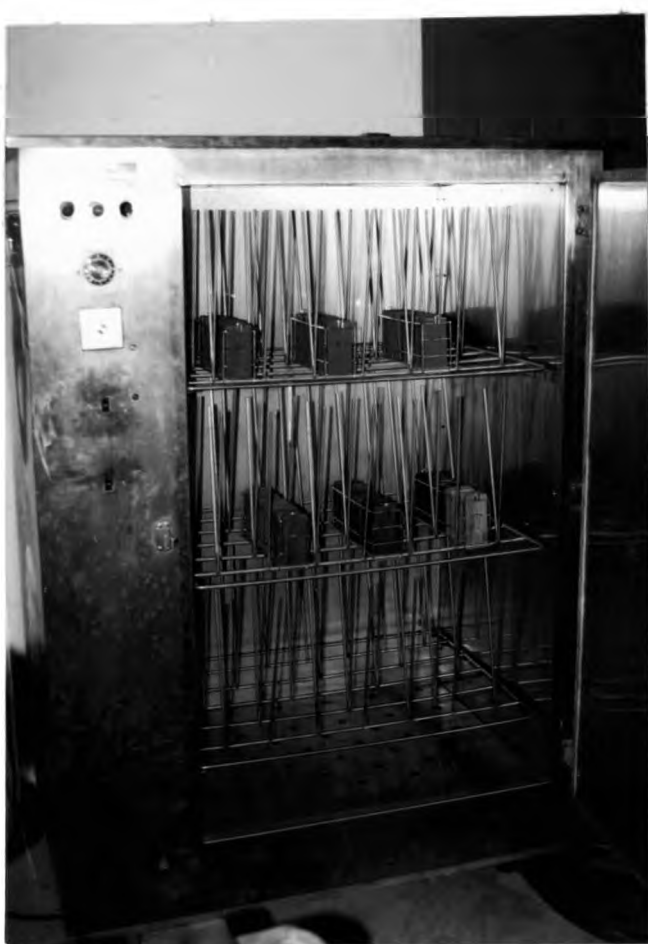
รูปที่ 3.8 การศึกษาความคงทนด้วยวิธีแบบวงจร (อบที่อุณหภูมิ 90 องศาเซลเซียส เป็นเวลา 1 วัน)
