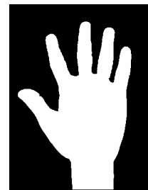
(ข) ภาพลักษณะฐานสองที่ผ่านขั้นตอน Opening และ Closing
