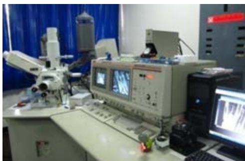
รูปที่ 3.8 กล้องจุลทรรศน์อิเล็กตรอนแบบส่องกราด (Scanning Electron Microscope)
