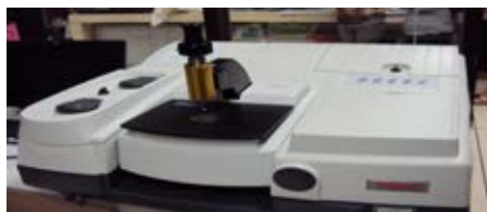
รูปที่ 3.5 เครื่อง Attenuated total reflectance infrared spectrometer (ATR-IR)
