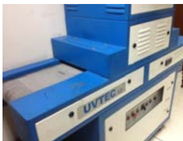
รูปที่ 3.2 เครื่องบ่มสารเคลือบผิวด้วยรังสียูวี
