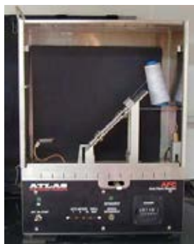
รูปที่ 3.9 เครื่องทดสอบความสามารถในการลุกลามของเปลวไฟในแนว 45 องศา (Atlas 45 0 automatic flammability tester)
