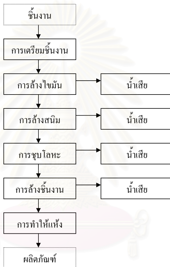
รูปที่ 2.2 ขั้นตอนการชุบโลหะด้วยไฟฟ้า
