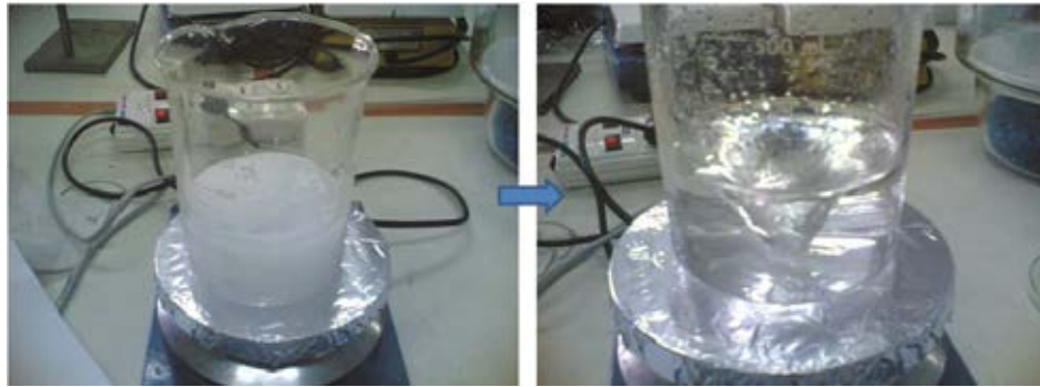
รูปที่ 3.3 การกวนสารด้วยเครื่องกวนสารแบบแม่เหล็กและแท่งกวนสารแม่เหล็ก
