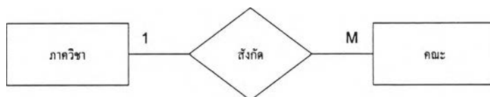
รูปที่ 2.41 แสดงความสัมพันธ์ชนิดหนึ่งต่อกลุ่ม
