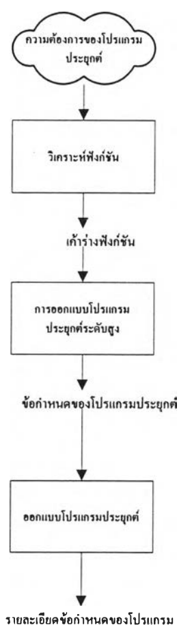
รูปที่ 2.29 การออกแบบฐานข้อมูลแบบให้ความสำคัญฟังก์ชัน [8]
