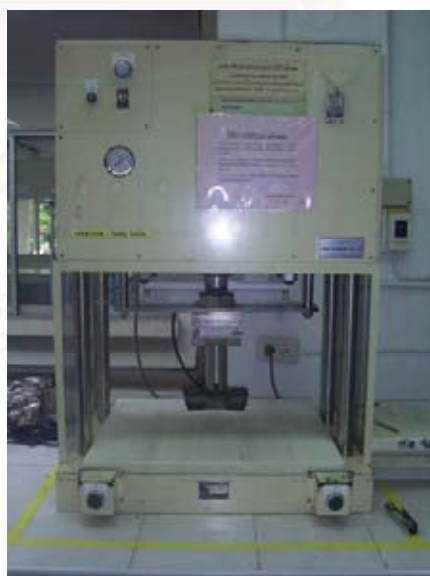
รูปที่ 3.14 เครื่องตัดตัวอย่างแบบใช้กำลังลม
