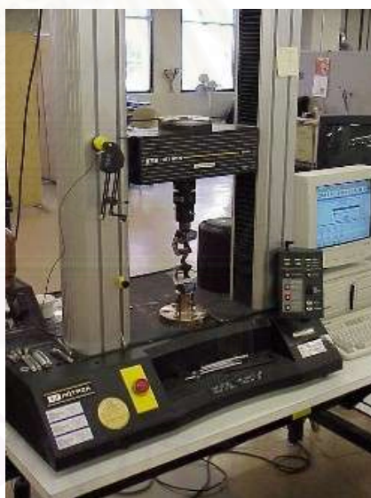
รูปที่ 3.20 เครื่องทดสอบการฉีกขาด (tear tester)
