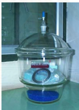
รูปที่ 3.5 โถแก้วดูดความชื้น (Desiccator)
