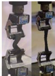
รูปที่ 3.23 ลักษณะการดึงตัวอย่างสำหรับทดสอบความทนแรงฉีก
