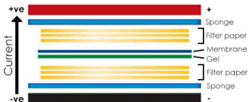
รูปที่ 13 : การเตรียมตัวอย่างของเทคนิค Western blot (general-western-blot-protocol, abcam company)
