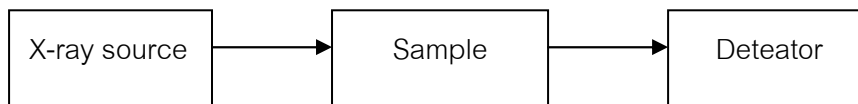
รูปที่ 3.8 แสดงหลักการทำงานของเครื่อง XRD โดยสังเขป
