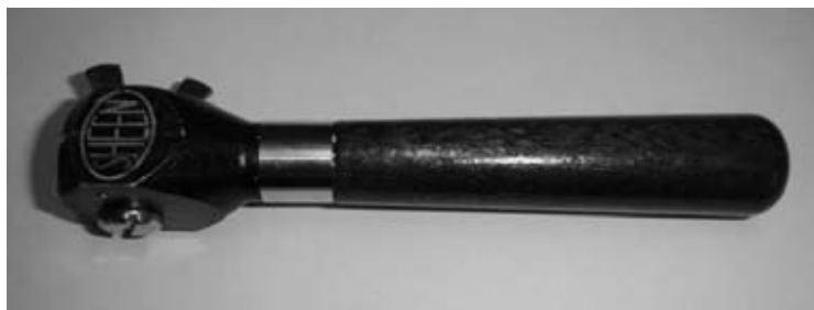
รูปที่ 3.14 แสดงเครื่องทดสอบความตืดแน่น ด้วยวิธี cross-cut tape
