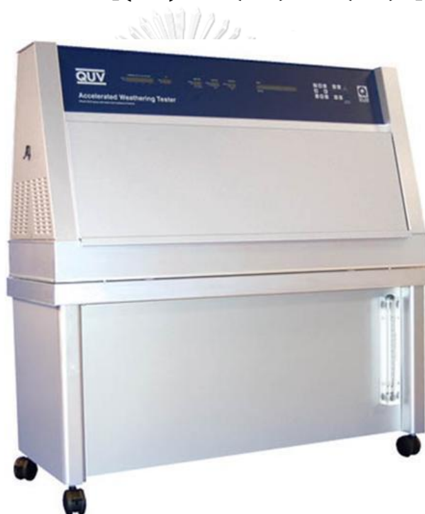
ภาพที่ 3.10 เครื่องทดสอบ QUV Accelerated Weathering Tester
