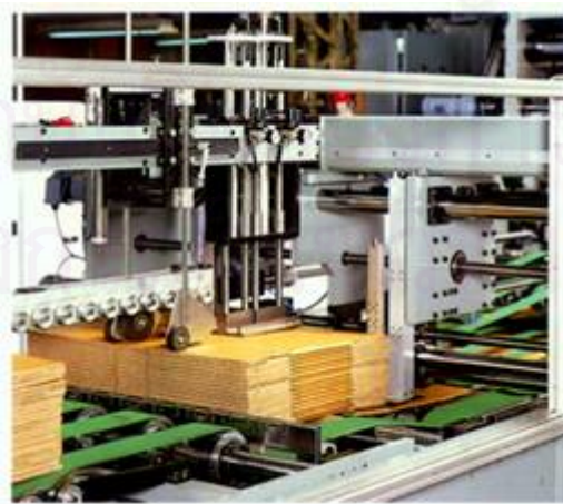
รูปที่ 3.34 ชุดเคาน์เตอร์และอีเจคเตอร์ (Counter & Ejector)
