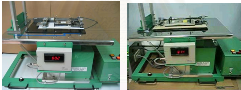
รูปที่ 4.5 แสดงการทดสอบโดยใช้เครื่อง Friction Test ตามแนวMD
