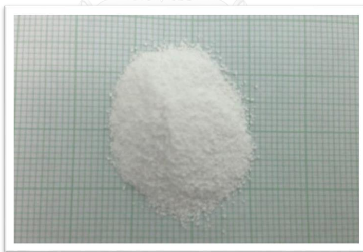
ภาพที่ 4. 10 โซเดียมอะลูมิเนตที่เตรียมได้จากอะลูมินาที่ใช้งานแล้ว
