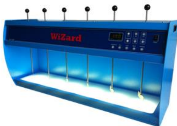
ภาพที่ 2. 8 อุปกรณ์ในการทำจาร์เทสต์ (เพิ่มพูน ทองไพบุลย์, 2554)
