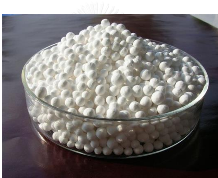
ภาพที่ 2. 2 ลักษณะของอะลูมินาดูความชื้น (จิราภรณ์ วงศ์สุวรรณ, 2556)
