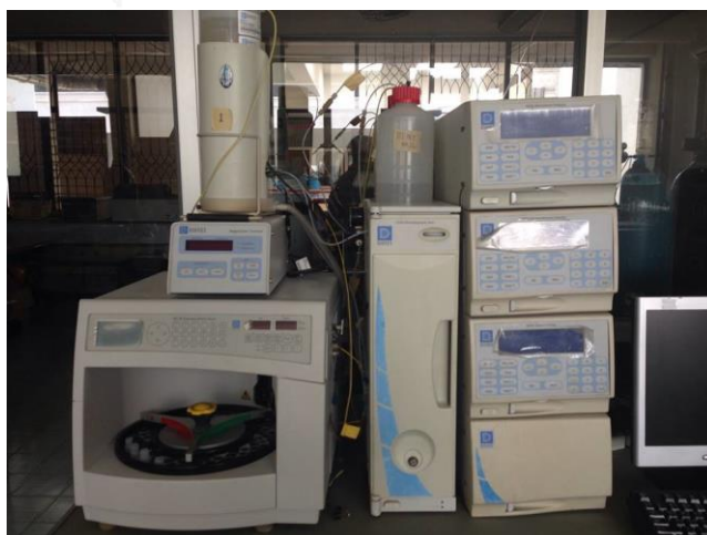
รูปที่ 3.2 เครื่องอออนโครมาโทกราฟรุ่น LC25 ยี่ห้อ DIONEX
