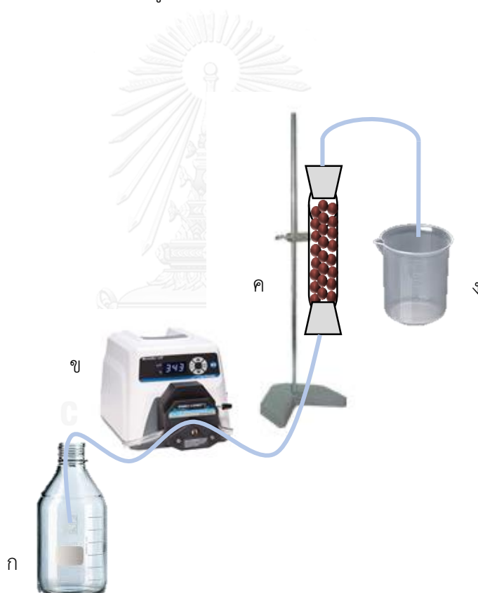
รูปที่ 3.2 แสดงการติดตั้งคอลัมน์ที่ใช้ในการวัดการฟื้นฟูสภาพเม็ดดูดซับ (ก) ถังบรรจุสารละลายฟลูออไรด์/สารละลายโซเดียมไฮดรอกไซด์ (ข) ปั๊มน้ำ (ค) คอลัมน์บรรจุเม็ดดูดซับ (ง) จุดเก็บน้ำ
