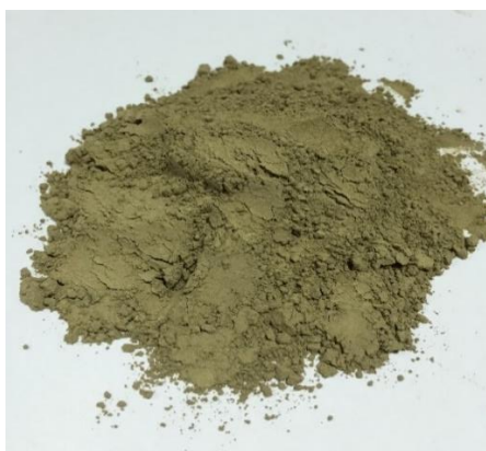
รูปที่ 4.4 ดินเหนียวที่ผ่านตะแกรงขนาด 100 เมช
