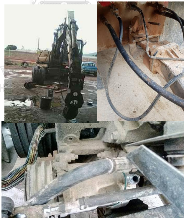
ภาพที่ 1.7 ตัวอย่างสภาพการเสียหายของเครื่องจักรในระบบไฮดรอลิก (สายไฮดรอลิกแตก/ขาด/ชำรุด)
