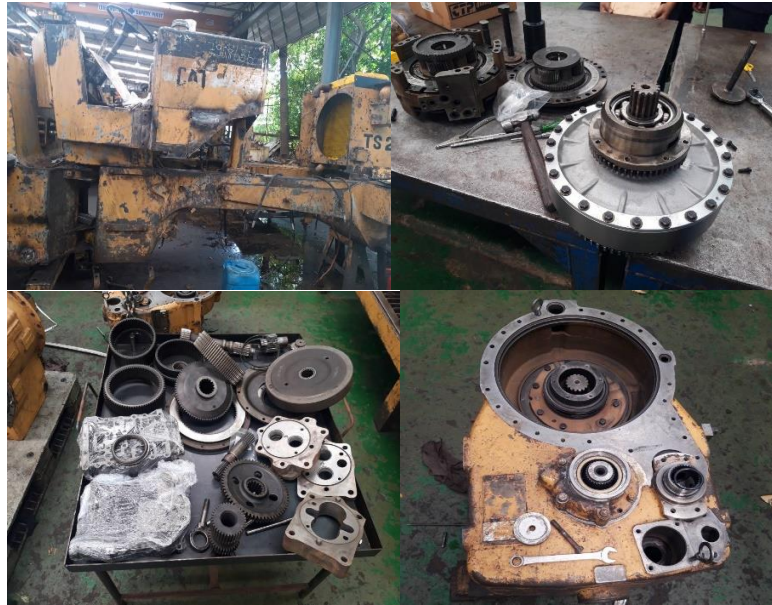
ภาพที่ 1. 8 ตัวอย่างสภาพการเสียหายของเครื่องจักรในระบบเกียร์ (ระบบเกียร์ชุดข้อและคลัทช์ชำรุด)
