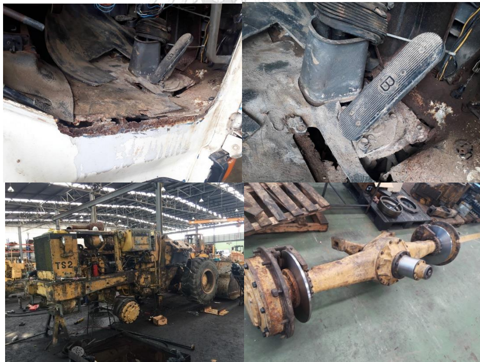
ภาพที่ 1. 9 ตัวอย่างสภาพการเสียหายของเครื่องจักรในระบบเบรก (เบรกชุดข้อ)
