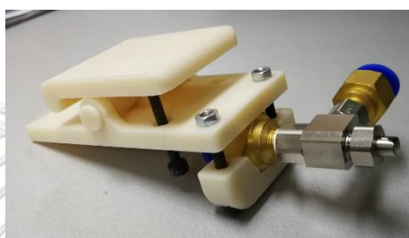
รูปที่ 3.11 ตัวอย่างชิ้นงานอุปกรณ์จับยึดหัวพ่น
