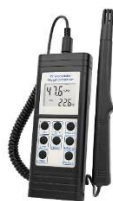
รูปที่ 3.16 เครื่องวัดความชื้นสัมพัทธ์ (hygrometer) (Grainger, 2018)
