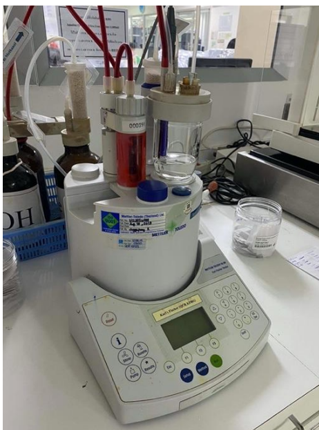
รูปที่ 5.4 เครื่องมือ Volumetric Karl Fischer Titrator รุ่น V30 ยี่ห้อ Mettler Toledo
