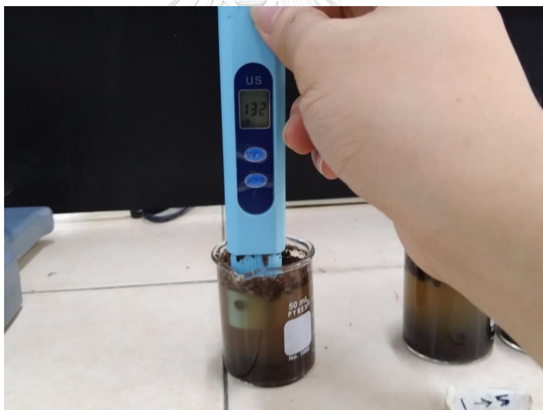
ภาพที่ ค-12 การวัดสภาพการนำไฟฟ้า
