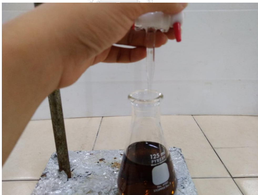
ภาพที่ ค-14 การวัด OM และ OC ด้วย Walkey and Black method (ระหว่างไตเตรต)
