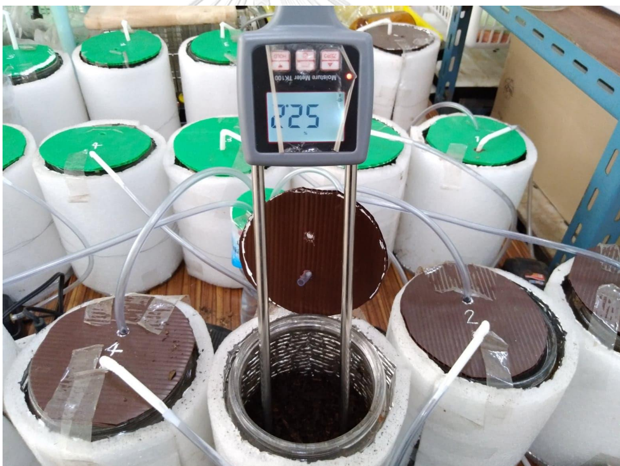
ภาพที่ ค-8 การวัดความชื้นสะสมสำหรับตัวแปรระหว่างการหมัก
