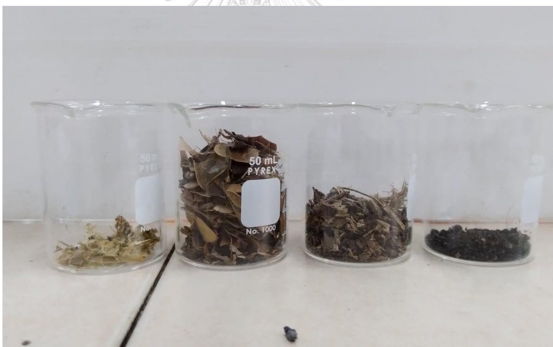
ภาพที่ ค-10 การวัดความชื้นสะสมสำหรับตัวแปรก่อนและหลังหมัก (หลังอบ)
