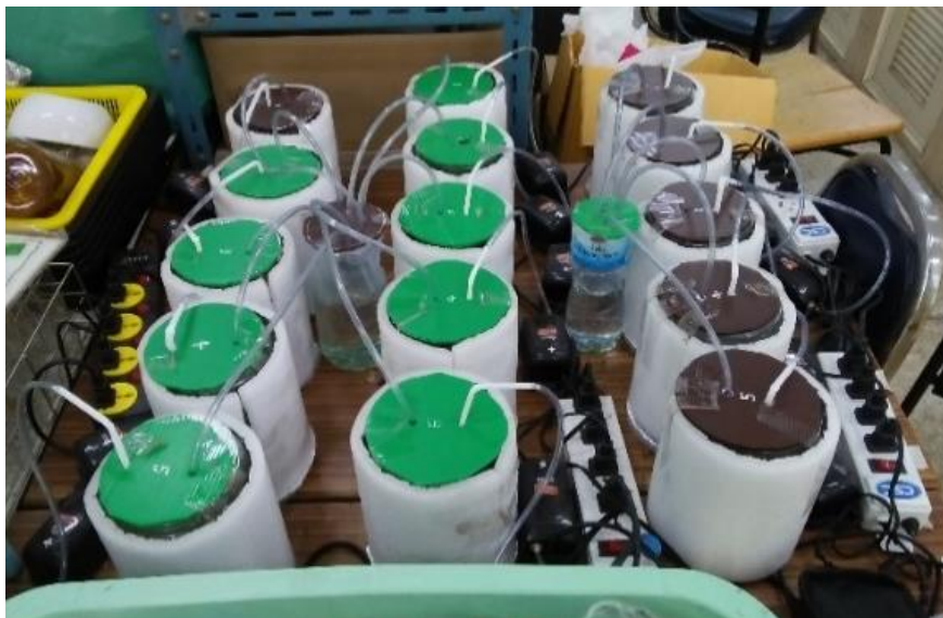
ภาพที่ 4-3 ระบบการทดลองทำปุ๋ยหมักขนาด 1.25 ลิตร
