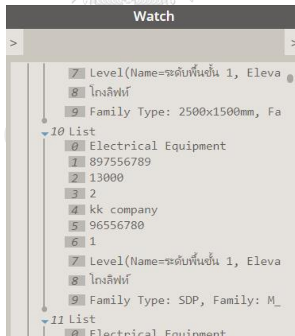
รูปที่ 7.10 ตัวอย่างการส่งผ่านข้อมูลของหมวดหมู่ Electrical Equipment จากแบบจำลอง as-built BIM
