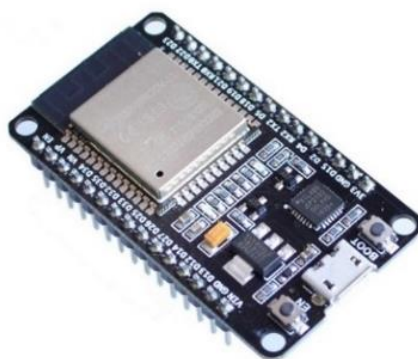
รูปที่ 4-4 ไมโครคอนโทรลเลอร์ ESP32 (Node MCU-32S)
