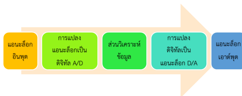
รูปที่ 3-4 สัญญาณแอนะล็อกเชื่อมต่อกับระบบดิจิทัล
