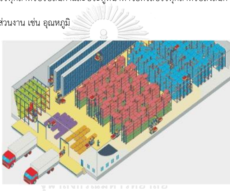
รูปที่ 2-5 ตัวอย่างแผนผังการไหลแบบโมดูล (Modular Flow Warehouse) [31]
