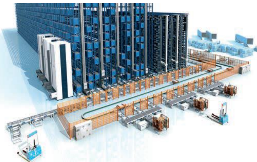
รูปที่ 2-8 ตัวอย่างการใช้อุปกรณ์ VLM ภายในคลังสินค้า [26]
