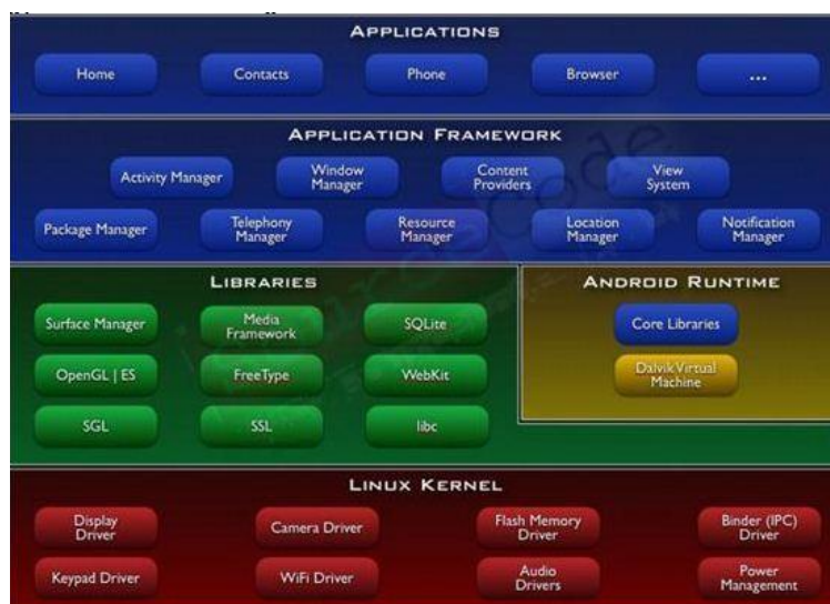
รูปที่ 2 โครงสร้างของระบบปฏิบัติการแอนดรอยด์ [12]
