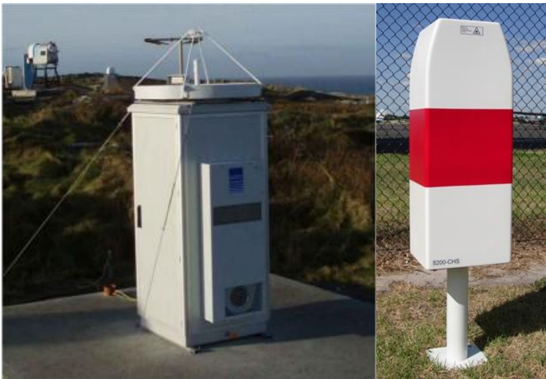
รูปที่ 5 (ซ้าย) เรดาร์ตรวจจับเมฆ MIRA-35 [10] และ(ขวา) Ceilometer 8200-CHS [11]
