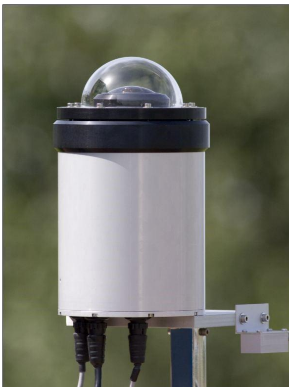
รูปที่ 9 กล้องตรวจอากาศรุ่น OMEA 3x/6x [22]
