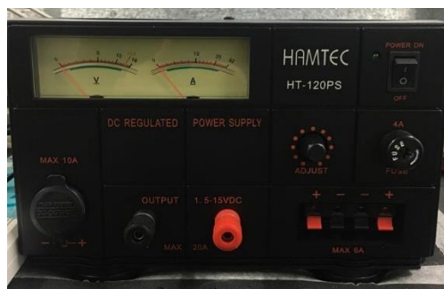
รูปที่ 5.14 เครื่องจ่ายไฟฟ้ากระแสตรง
