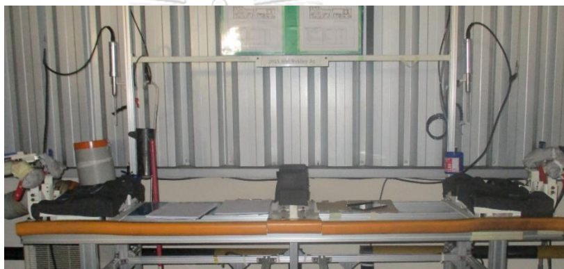
รูปที่ 3.6 แท่นรองชิ้นงานระหว่างทำการเชื่อม
