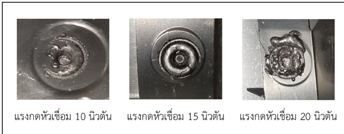
รูปที่ 4.10 รอยเชื่อมของแรงกดหัวเชื่อม 3 ระดับที่ความหนาของผิวเชื่อม (2.5 มิลลิเมตร) และเวลาที่ใช้ในการเชื่อม (5 วินาที) ระดับเดียวกัน
