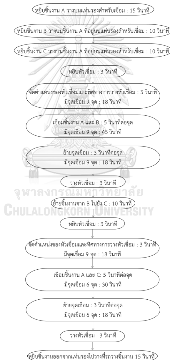
รูปที่ 3.2 กระบวนการย่อยของกระบวนการเชื่อมพลาสติก
