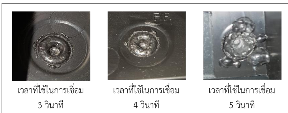
รูปที่ 4.9 รอยเชื่อมของเวลาที่ใช้ในการเชื่อม 3 ระดับที่ความหนาของผิวเชื่อม (2.5 มิลลิเมตร) และแรงกดหัวเชื่อม (20 นิวตัน) ระดับเดียวกัน
