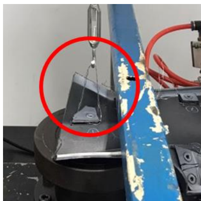
รูปที่ 3.9 ลักษณะการผูกมัดเข้ากับชิ้นงานเพื่อทำงานทดสอบความต้านทานแรงดึง 3.4.14 ทดสอบความต้านทานแรงดึงของจุดเชื่อม
