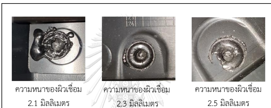
รูปที่ 4.8 รอยเชื่อมของความหนาของผิวเชื่อม 3 ระดับที่เวลาที่ใช้ในการเชื่อม (3 วินาที) และแรงกดหัวเชื่อม (20 นิวตัน) ระดับเดียวกัน
