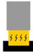
รูปที่ 2.10 ขั้นตอนเชื่อมชิ้นงานของการเชื่อมพลาสติกแบบอัลตราโซนิค
