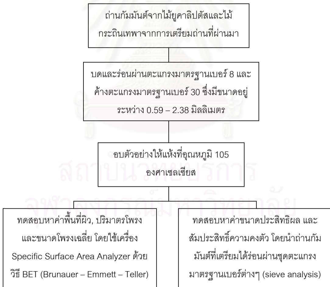
รูปที่ 3.2 ขั้นตอนการศึกษาคุณสมบัติของถ่านกัมมันต์
