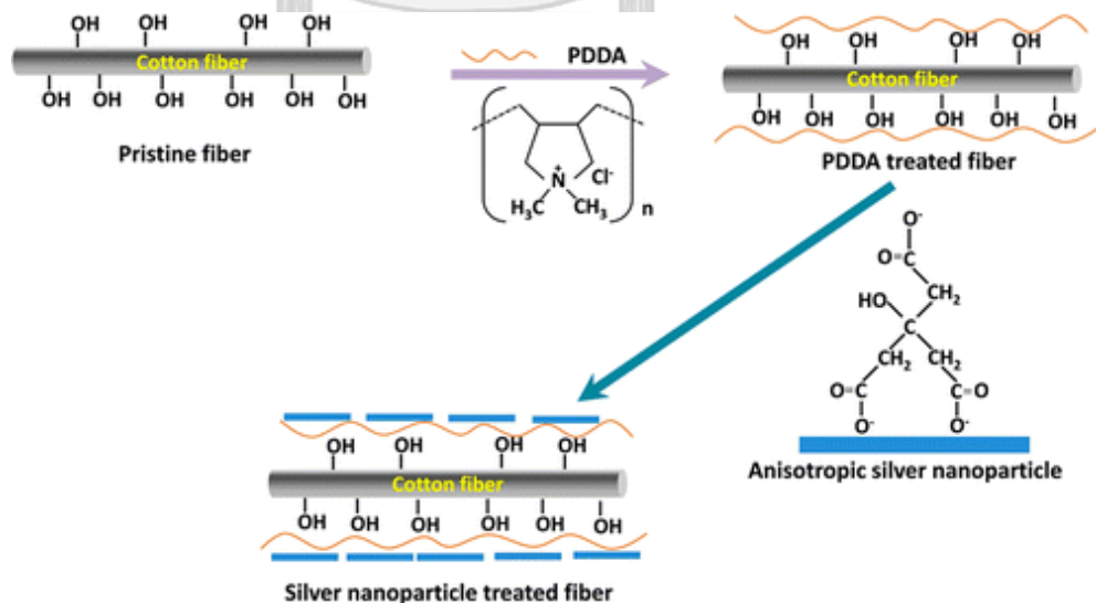
รูปที่ 2.12 แรงดึงดูดไฟฟ้าสถิต (electrostatic attraction) ระหว่างเส้นใยฝ้ายที่ผ่านการปรับผิวด้วย PDDA ให้มีประจุที่เป็นบวกกับอนุภาคนาโนซิลเวอร์ที่มีประจุที่ผิวเป็นลบ [24]
