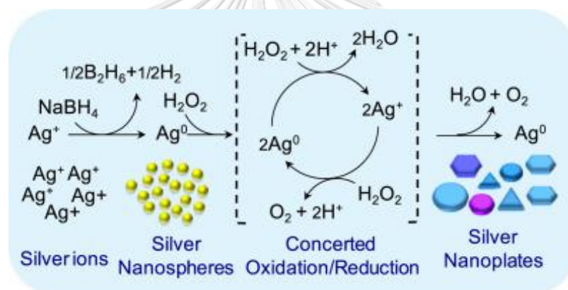
รูปที่ 2.10 กระบวนการเปลี่ยนรูปร่างของอนุภาคนาโนซิลเวอร์ทรงกลม (silver nanospheres) ให้เป็นอนุภาคนาโนซิลเวอร์แบบแผ่น (silver nanoplates)
