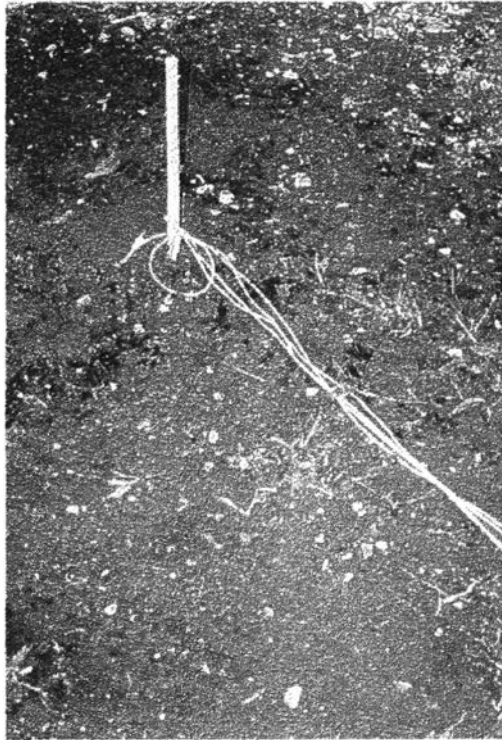
รูปที่ 17 แสดงการตรวจวัดอุณหภูมิผิวดินและอุณหภูมิดินเปียก
