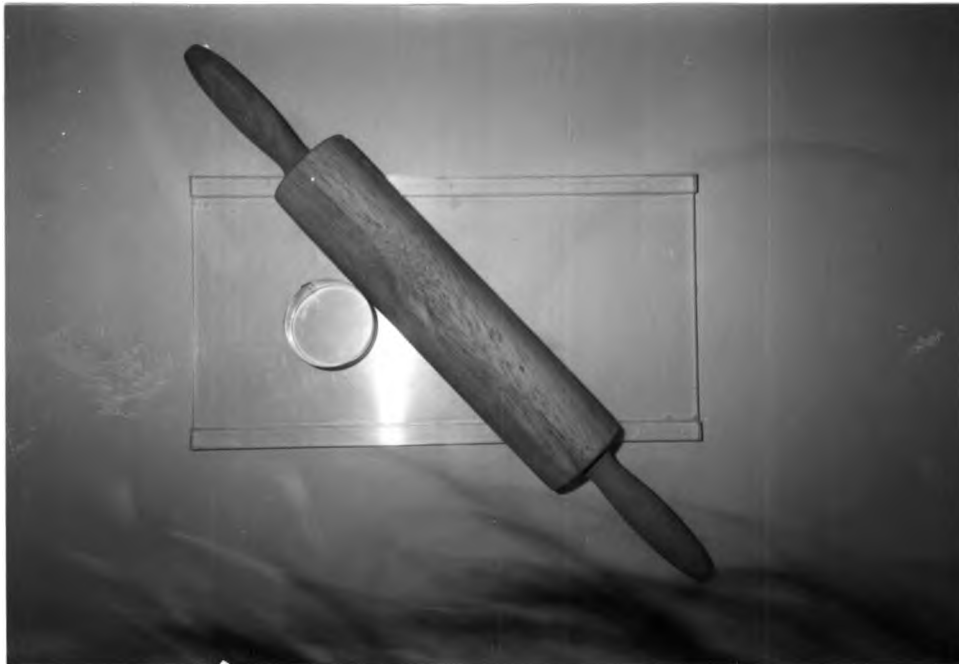
รูปที่ ก.10-1 พลาสติกสำหรับวัดคุกกี้เป็นแผ่นควบคุมความหนาอยู่ในช่วง 7 มิลลิเมตร ไม้คัลลิ่ง สำหรับรีดแป้งออกเป็นแผ่น และพิมพ์กดคุกกี้ขนาดเส้นผ่านศูนย์กลาง 60 มิลลิเมตร
