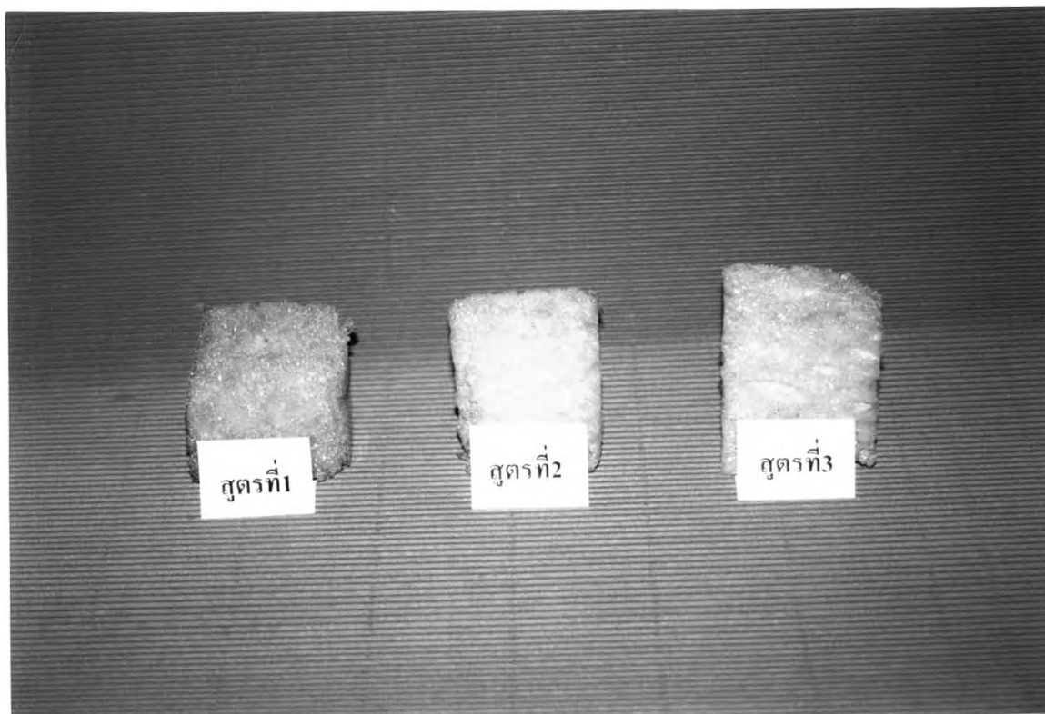
รูปที่ 4.9 โฟมพอลิยูรีเทนสูตรที่ 1 สูตรที่ 2 และ สูตรที่ 3
