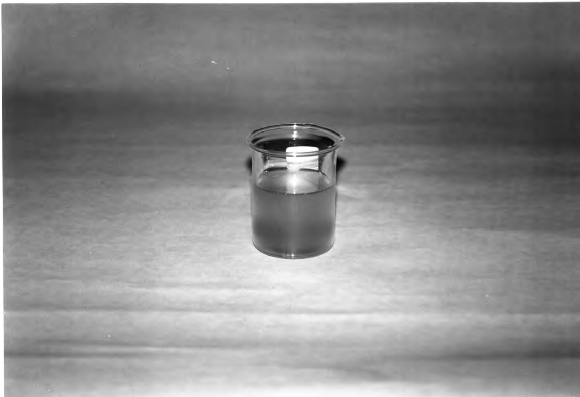
รูปที่ 4.5 พอลิเอสเตอร์พอลิออลที่สังเคราะห์จากไกลโคไลซ์โพรดักต์
