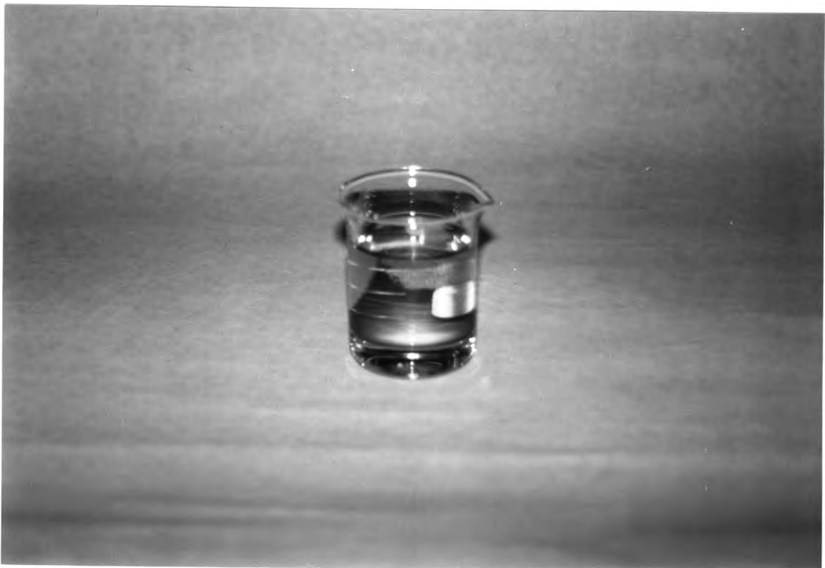
รูปที่ 4.1 ไกลโคไลซ์โพรดักส์ที่สังเคราะห์ได้จากการไกลโคไลซิสขวดพลาสติกที่ใช้แล้ว
