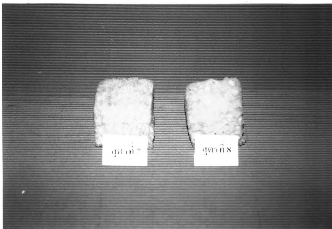
รูปที่ 4.11 โฟมพอลิยูรีเทนสูตรที่ 7 และ สูตรที่ 8
