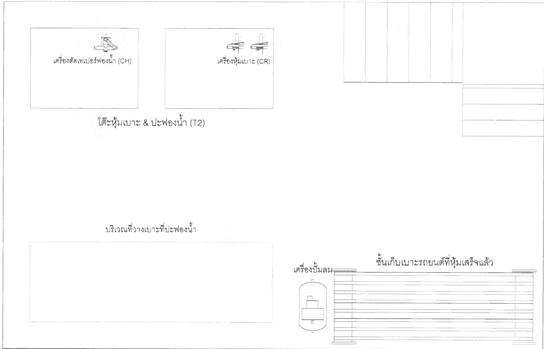
รูปที่ 3.2 แสดงการวางเครื่องจักรสำหรับงานหุ้มเบาะรถยนต์ในแผนกหุ้มและสกรีน (ชั้นที่ 2)
