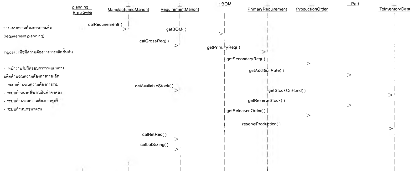
รูปที่ 5.22 แผนภาพซีควเอนซ์แสดงการวางแผนความต้องการการผลิต
