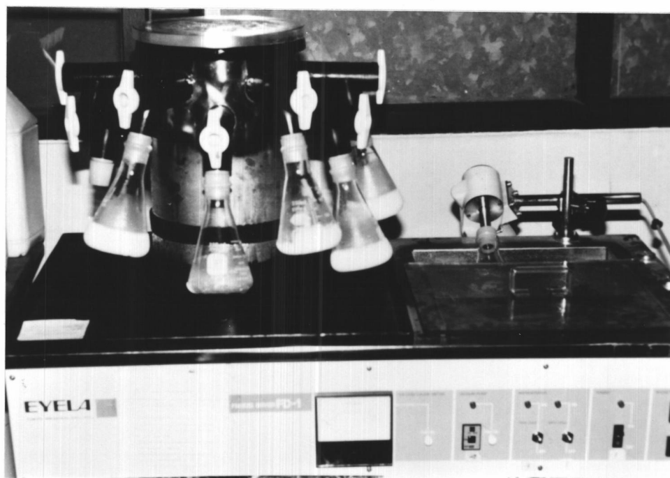
รูปที่ 3.10 การทำแห้งสารสกัดจากปลาด้วยวิธีแช่เยือกแข็ง
