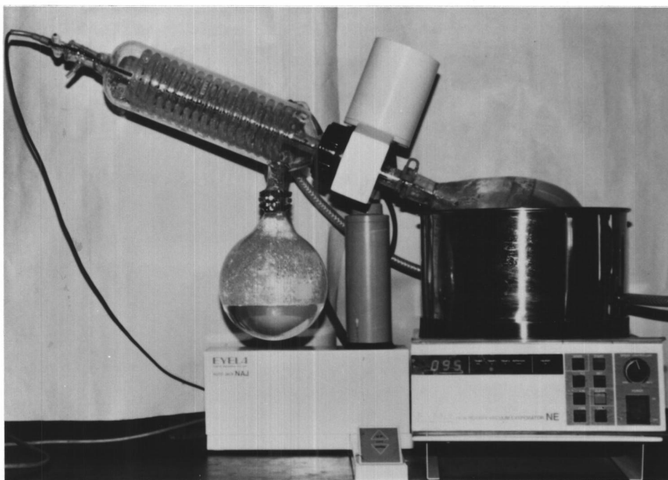
รูปที่ 3.8 การทำเข้มข้นสารสกัดจากปลาภายใต้ภาวะสุญญากาศ
