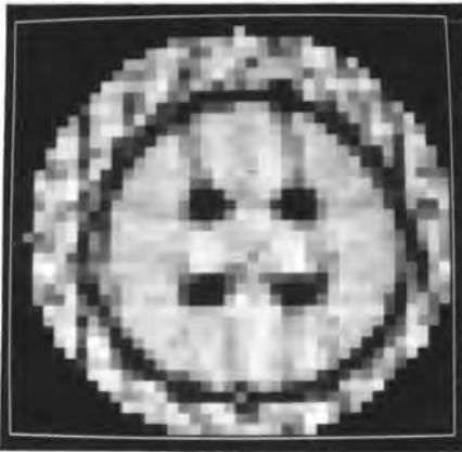
รูปที่ 4.4 ภาพโทโมกราฟีของชิ้นงานที่ 1 จากการคำนวณข้อมูล 18 โพรไฟล์ ระยะห่างระหว่างเรย์ซัม 3 มิลลิเมตร
