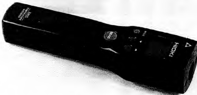
รูปที่ 3-1 เครื่องวัดอุณหภูมิแบบไม่สัมผัสกับพื้นผิว (HIOKI 3415 Temperature Hitester)
