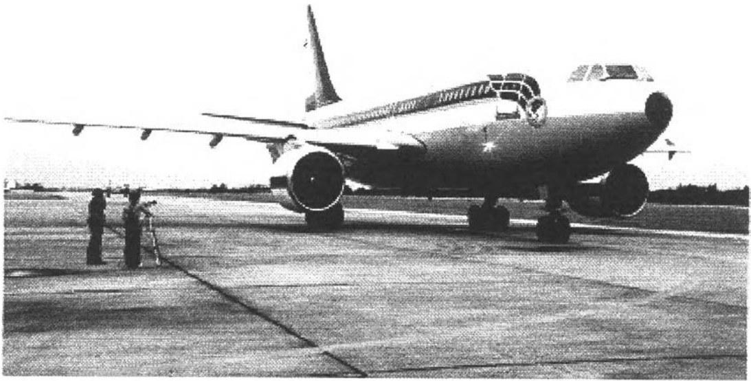
ภาพ ผ.4 การตรวจวัดระดับเสียงของเครื่องบินไอพ่น (A310)
