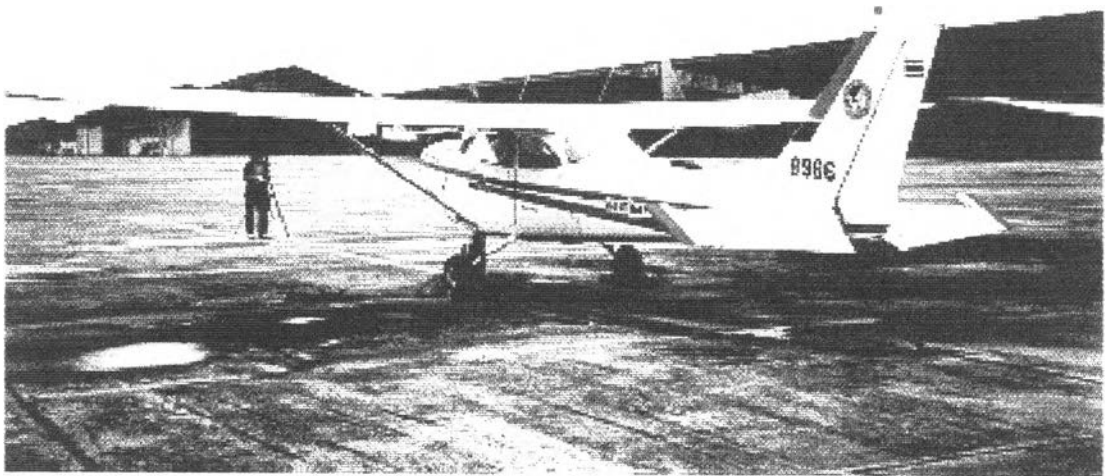
ภาพ ผ.5 การตรวจวัดระดับเสียงของเครื่องบินใบพัดขนาดเล็ก (T41D)
