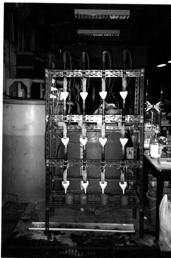
รูปที่ 4.1 การติดตั้งอุปกรณ์เพื่อศึกษาผลความสูงชั้นตัวกลางที่มีต่อประสิทธิภาพการกำจัดนิกเกิล
