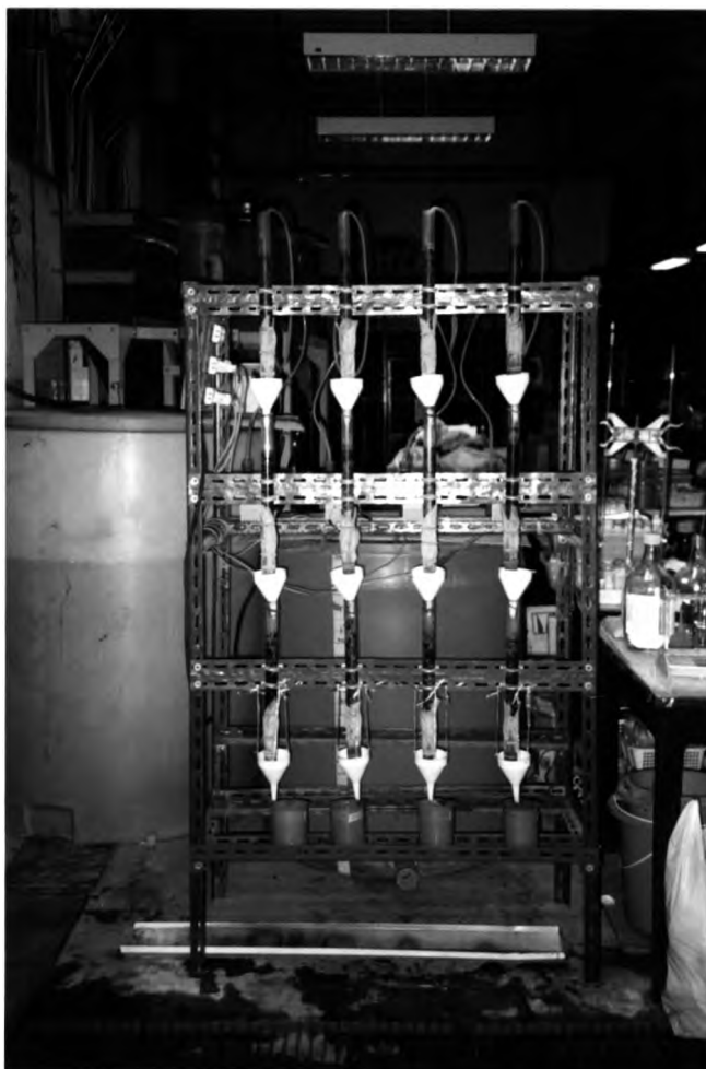
รูปที่ 4.5 การติดตั้งอุปกรณ์เพื่อศึกษาผลของอัตราไหลที่มีต่อประสิทธิภาพการกำจัดนิกเกิล
