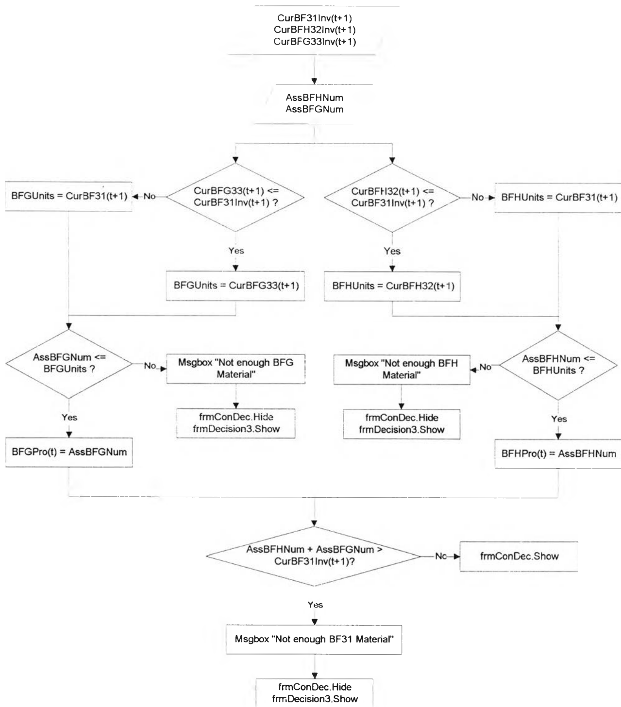
รูปที่ 4.26 แผนภูมิการไหลของการตรวจสอบวัสดุที่ใช้ในการประกอบ BFH และ BFG ของระดับความยากที่ 2 และ 3
