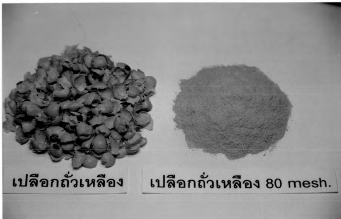
รูปที่ ก2 เปลือกถั่วเหลืองก่อนบด และหลังบดและร่อนแล้ว
