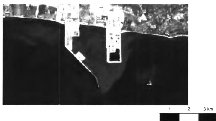
รูป 3.11 ภาพผสมสีเท็จข้อมูลดาวเทียม Landsat TM แบนด์ (5,3,1 : R,G,B) วันที่ 10 พฤศจิกายน 2537 (ช่วงหลังการถมทะเลระยะที่ 1)
