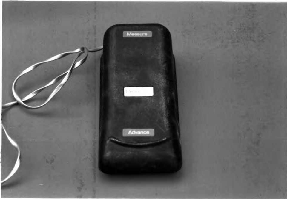
ภาพที่ 7 แสดงภาพสวิตซ์เท้าของเครื่องเพริโอเทมปี
