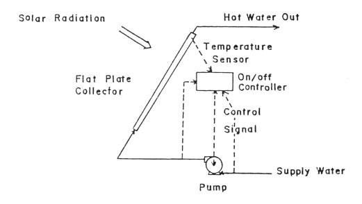
FIGURE 3.1A SIMPLE SOLAR WATER HEATING SYSTEM
