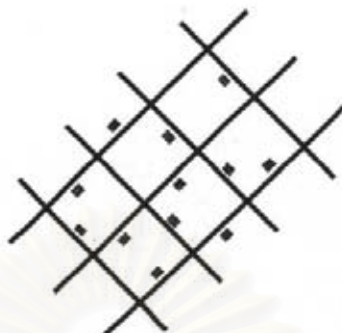
รูปที่ 2-6 รูปช่องตารางแบบกระจาย (Dispersal Grid)
