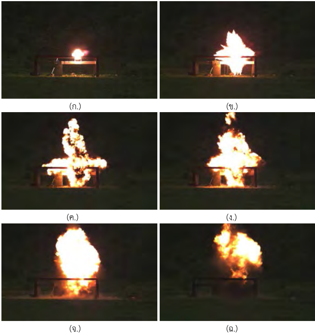
รูปที่ 39 แรงระเบิด และเปลวไฟจากระเบิด TNT 2 ปอนด์ กระทำต่อเสา NRC-50-1 (ก.)เริ่มจุดระเบิด แรงระเบิดเริ่มกำลังกระทำต่อเสาที่เวลา 0.2770 s (ข.)แรงระเบิดกระทำต่อเสาที่เวลา 0.2773 s (ค.)แรงระเบิดที่กระทำต่อเสาที่เวลา 0.2803 s (ง.)แรงระเบิดที่กระทำต่อเสาที่เวลา 0.2893 s (จ.)แรงระเบิดที่กระทำต่อเสาที่เวลา 0.3103 s (ฉ.)แรงระเบิดที่เคลื่อนที่ออกจากเสาที่เวลา 0.243 s 4.2 การศึกษาสภาพความเสียหายเสาคอนกรีตเสริมเหล็กหลังจากที่ทดสอบระเบิด
