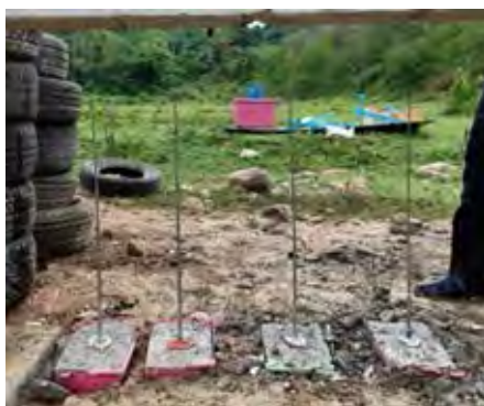
รูปที่ 21 อุปกรณ์วัดการเคลื่อนตัว
