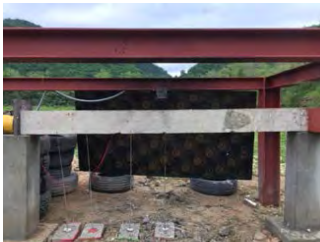
รูปที่ 32 เสาคอนกรีตเสริมเหล็กถูกติดตั้งบนแท่นทดสอบ
