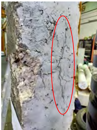
รูปที่ 55 สภาพการเกิดรอยร้าวแบบเฉือนของเสา NRC-Large
