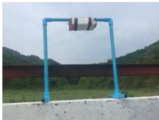
รูปที่ 38 ติดตั้งวัตถุระเบิด TNT ขนาด 0.91 kg ไว้ที่จุดกึ่งกลางของเสาคอนกรีตเสริมเหล็ก
