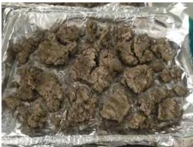
ภาพที่ ค. 1 ตะกอนอบแห้ง 103 \pm 2 องศาเซลเซียส
